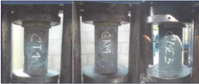
Fotografías de las pruebas de resistencia mecánica en Kg/cm 2
